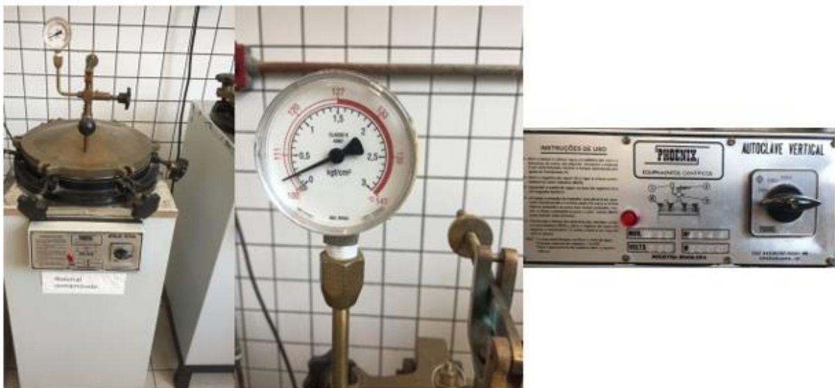
Figura 7 – Autoclave manual Apoio 2 e etapas para seu funcionamento
