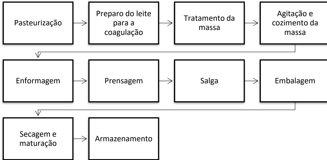
Figura 2 – Exemplo de um processo de fabricação de queijo em diagrama de blocos
